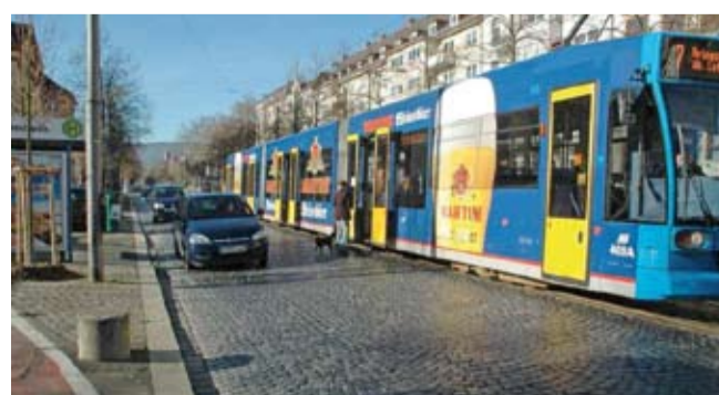
Die Haltestelle in der Goethestraße: Fahrgäste steigen auf der Fahrbahn aus. Sie ist nicht barrierefrei nutzbar
